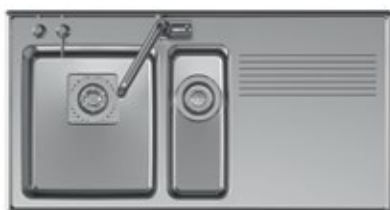
Intra Frame FR97SH. 970x510 mm. Skapbredde minst 600 mm. Oppløftsventil og rensesil i den store kummen og manuell kurvventil i den lille. Oppvaskmid- delpumpe. NU
