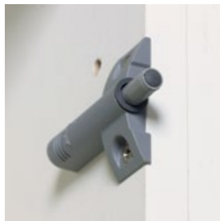
Dørdemper Soft. Lydløs, dempet lukking av skapdøren. Tilbehør som bores inn i skapsiden eller monteres i holdere.
