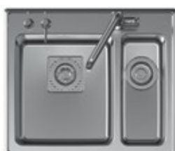
Intra Frame FR60SH. 595x510 mm. Skapbredde minst 600 mm. Oppløftsventil og rensesil i den store vasken og manuell kurvventil i den lille. Oppvaskmiddelpumpe. NU
