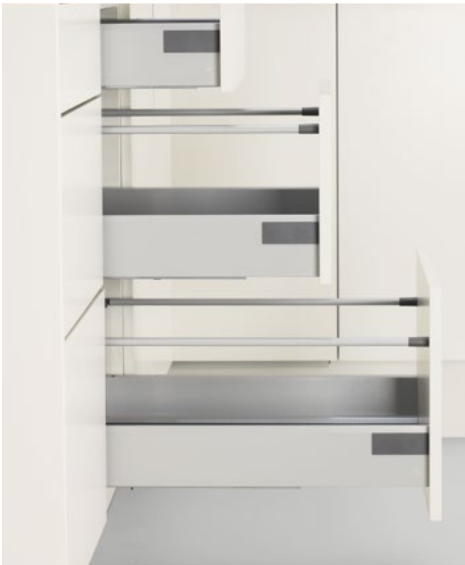
Tandemboxskuffer. Forsynt med skuffedempere, fullt uttrekk i alle skuffer, doble stålsider med innebygd skinnesystem og 16 mm bunn. Finnes i bredde 40-80 cm. Skuffeskinner til høye 80 cm skuffer tåler en belastning på 50 kg. Øvrige skuffer har en skinne som tåler 30 kg.
